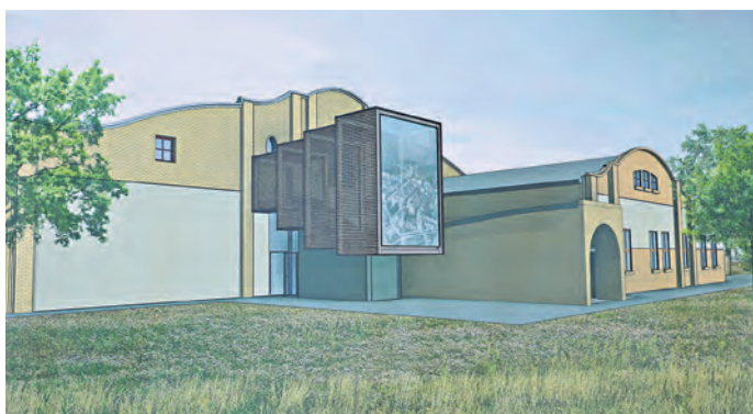
Rückseite des Gebäudes. Hier wird eine Treppenanlage als zweiter Fluchtweg angebaut und mit einer Verkleidung in Form einer alten Kamera versehen.
