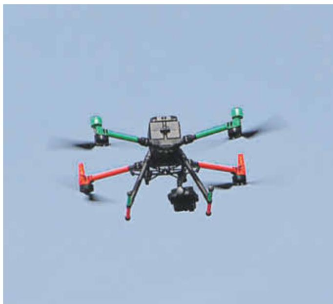
Die eingesetzte Drohne liefert Liveaufnahmen direkt zur Einsatzleitung.
