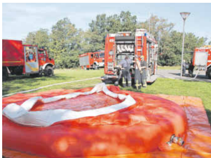
Die Kameraden befüllen den Faltbehälter mit 36.000 Liter Löschwasser.
